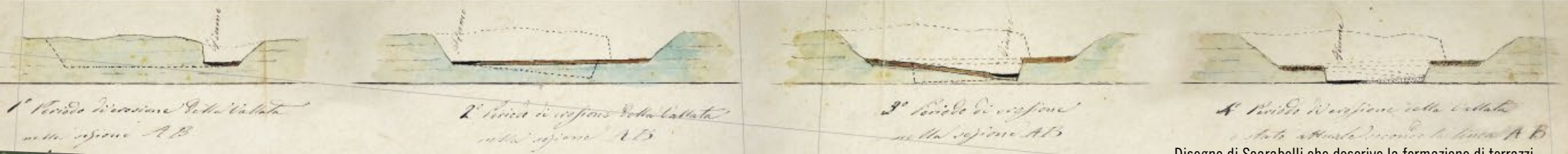
Disegno di Scarabelli che descrive la formazione di terrazzi alluvionali mano a mano che il fiume scava il proprio letto
